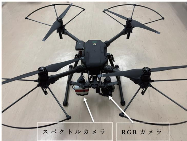
図2 ドローン本体およびセンサカメラ
