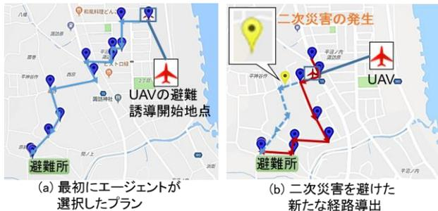
図 2. UAV による避難誘導経路のシミュレーション実験
