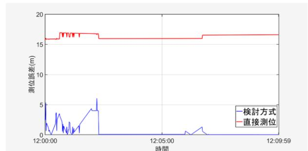
図4 9号機の水平測位誤差の時系列変化
