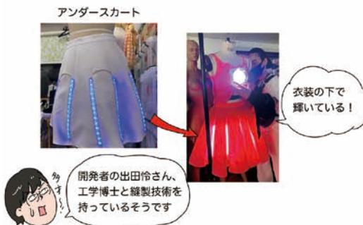
藤本 衣装デザインが決まったら、スカートに合わせてアンダースカートのトワルを出田が縫って配線を考えます。LEDが2,000個を超えたら1個のデバイスでは足りなくなるので、LEDの個数を計算しつつ配線を考えます。
