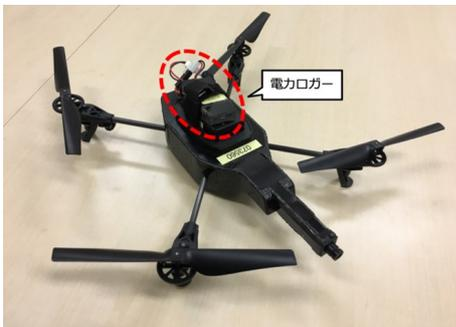
図 3: 電力ロガー搭載時のドローン
