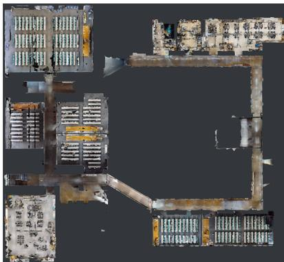
図 3 工学部 2 号館の点群データ。閉路の始点と終点の位置がずれている。
