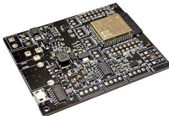
図 8 コネクタを外した新センサモジュール
