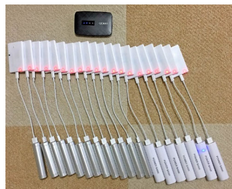
図8 温湿度センサとモバイルルータの接続
