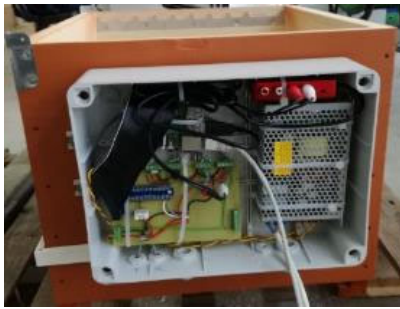
図3 巣箱に取付けたセンサ(左)と通信モジュール(右) [2]
