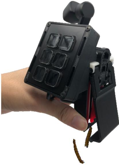
図 5 給餌機構ハンドカメラ
