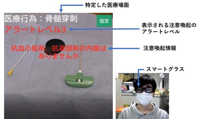
図 2 注意喚起情報表示例 (左) とスマートグラス装着イメージ (右)
