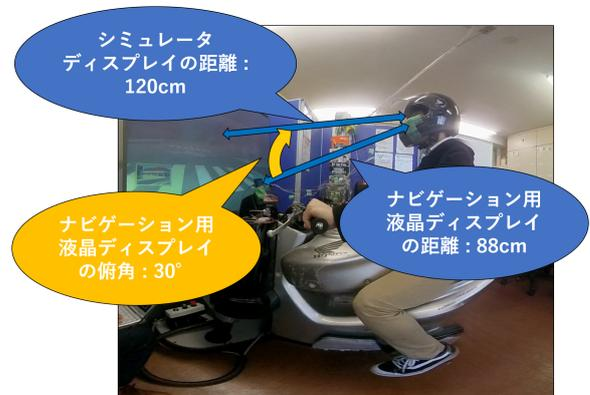
図 13 方向指示器操作実験風景
