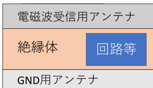
図3 タイル型センサノード構造図
