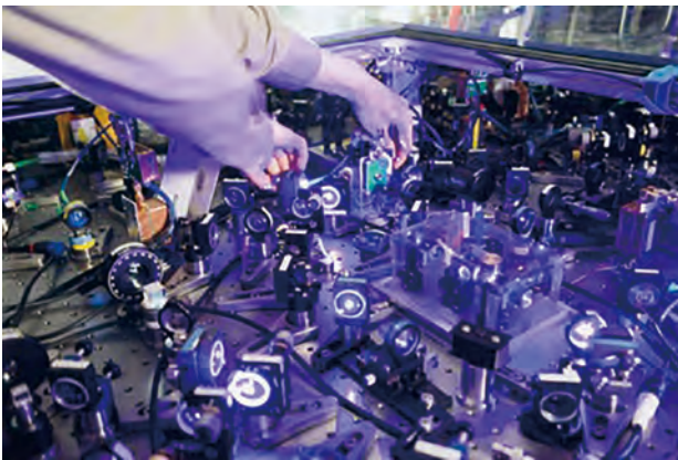
■図-1 光学定盤上でのアライメントの様子
