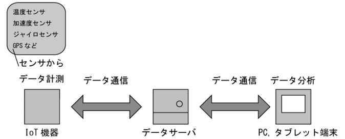
図 1 IoT システム概念図
