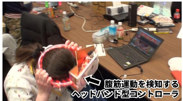
図 18 腹筋動作をリズムゲームの入力とする作例
