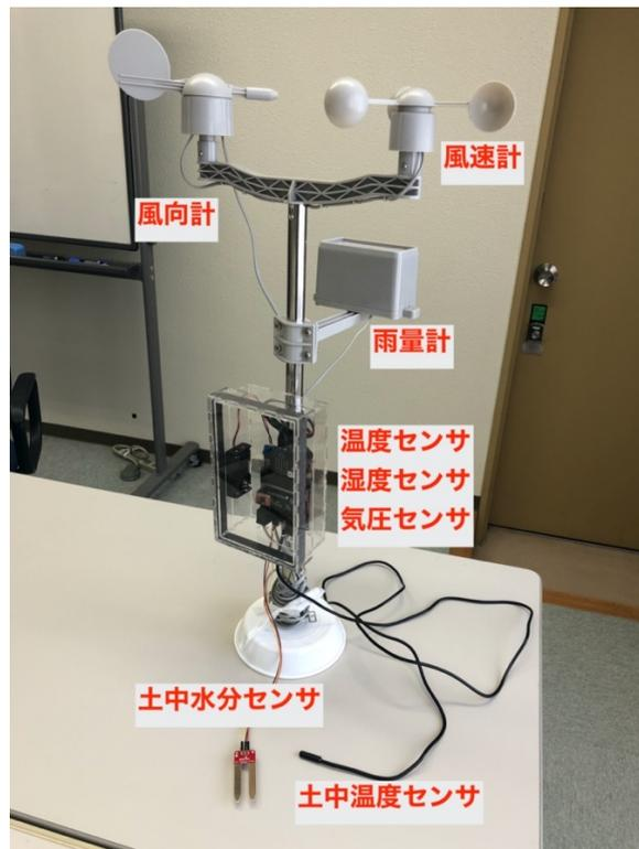
図 2 試作した水田気象観測装置
