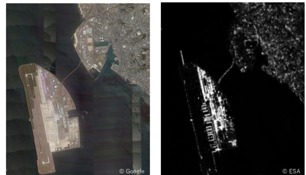
図 3 光学画像 (左図) と SAR 画像 (右図) の比較. 愛知県常滑市にある中部国際空港周辺の同範囲を撮影したものである. SAR 画像はマイクロ波の反射強度を表すモノクロ画像であり, 反射強度が高いほど白くなる. 人工構造物 (建物など) や岩石は反射強度が高い.
