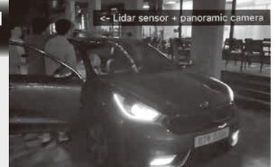
パノラマカメラとLidarセンサーを融合し車両の周囲の情報を取得。センサーからの同期画像を使用したYOLOをトレーニングデータに使用して他の車や物を検出する。
