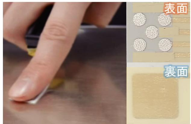
図2 複合触覚デバイス基本構成. 表面: 電気刺激用の電極 (右上), 裏面: 静電吸着用の電極 (右下)
