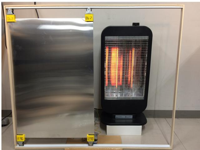
図5 アルミ板を用いた遮熱機構
