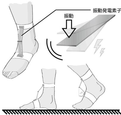
図1 足首装着型発電デバイスの仕組み
