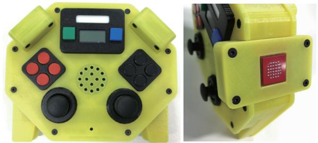
図2 *TactCon*の外観。左図：正面図、右図：触覚ディスプレイ部の拡大図
