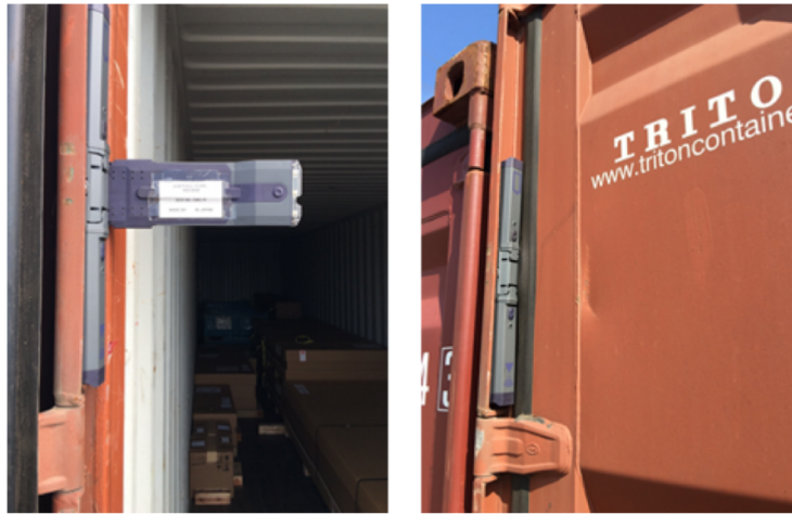
図5 コンテナにセンサを取り付けた様子
