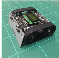
例として左の写真に示す小型ロボット Pololu Zumo 32U4\*2の制御プログラム\*3を図1に示す。このロボットは2つのモータ、ジャイロ・加速度・磁気センサ等を搭載し、マイクロコントローラ ATmega32U4 (RAM2.5KB, フラッシュメモリ 32KB)によって制御される。
