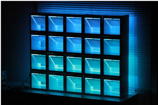
図 1 初期プロトタイプ 1: サーボモータによるモジュール扉の開閉と LED 制御が PC より可能となっている。各モジュールはマグネットコネクタにて接続され、ユーザが容易に構築可能である
