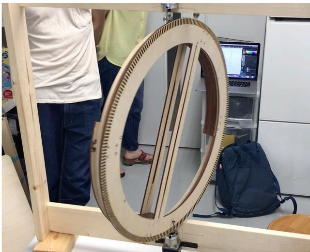
図 4 ラピッドプロトタイプ 1: 木材を利用して 2 軸動作を事前に作成した CG 動作ムービーと比較・検討した
