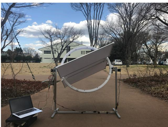
図 5 ラピッドプロトタイプ 2: 金属フレームと POM 樹脂を利用して回転軸等で細かな修正を行った.
