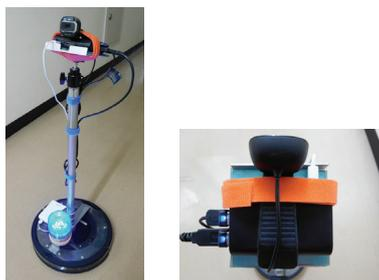
図 5 移動ロボットの外観 (左: 全体像, 右: 制御部)
