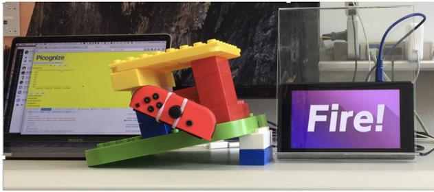
図 16 QuickDraw の自動操作の例。「Fire」の掛け声が検出されると Nintendo Switch のコントローラが IoT モータ Webmo によって回転し、銃を発射する入力が行われる
