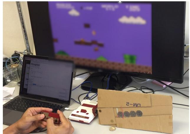
図 14 スーパーマリオブラザーズを用いた Toolification of Games 事例, 「Coins For Two」. コイン取得時の効果音を検出し、コインサーバから硬貨が排出される
