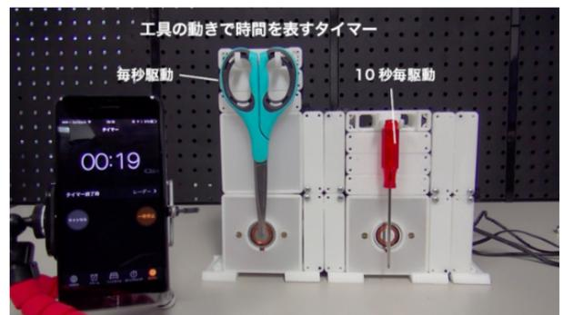
図 12 工具を用いたタイマーへの応用例
