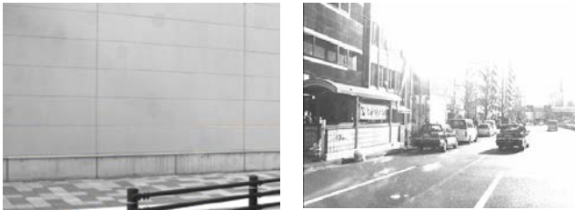
(a) 特徴が少ないシーン (b) 照明条件変化シーン 図 4 特徴点の照合が困難なシーン
