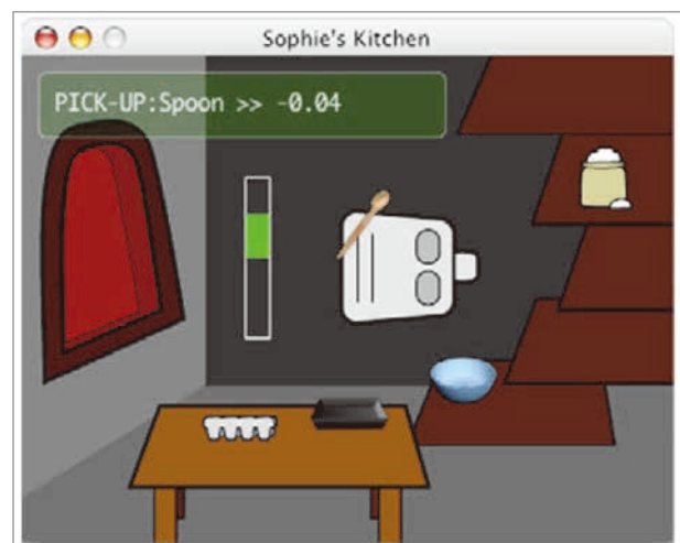
■ 図-3 Teachable robots. ロボットの行動に対して、ユーザが緑色のスライダで報酬を与える
