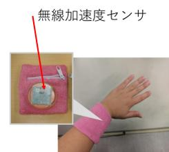
図 2 リストバンド型加速度センサ
