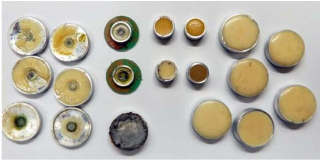
図 6 2008-2009 年に作成した体導音センサたち
