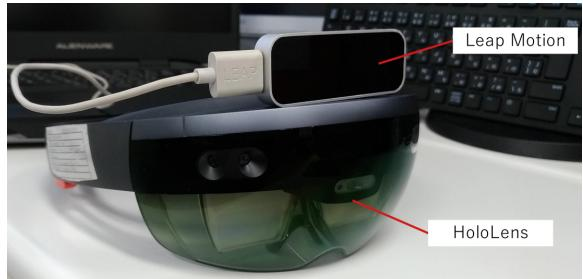
図 5: HoloLens に Leap Motion を取り付けた様子
