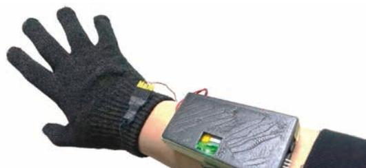
■図-14 Grov、計測回路を除くとただの毛糸の手袋にしか見えない
