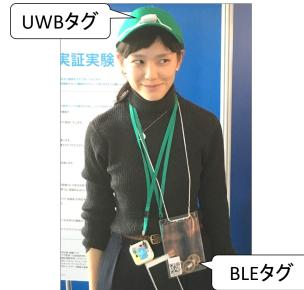
図 1 BLE タグ・UWB タグを装着した被験者
