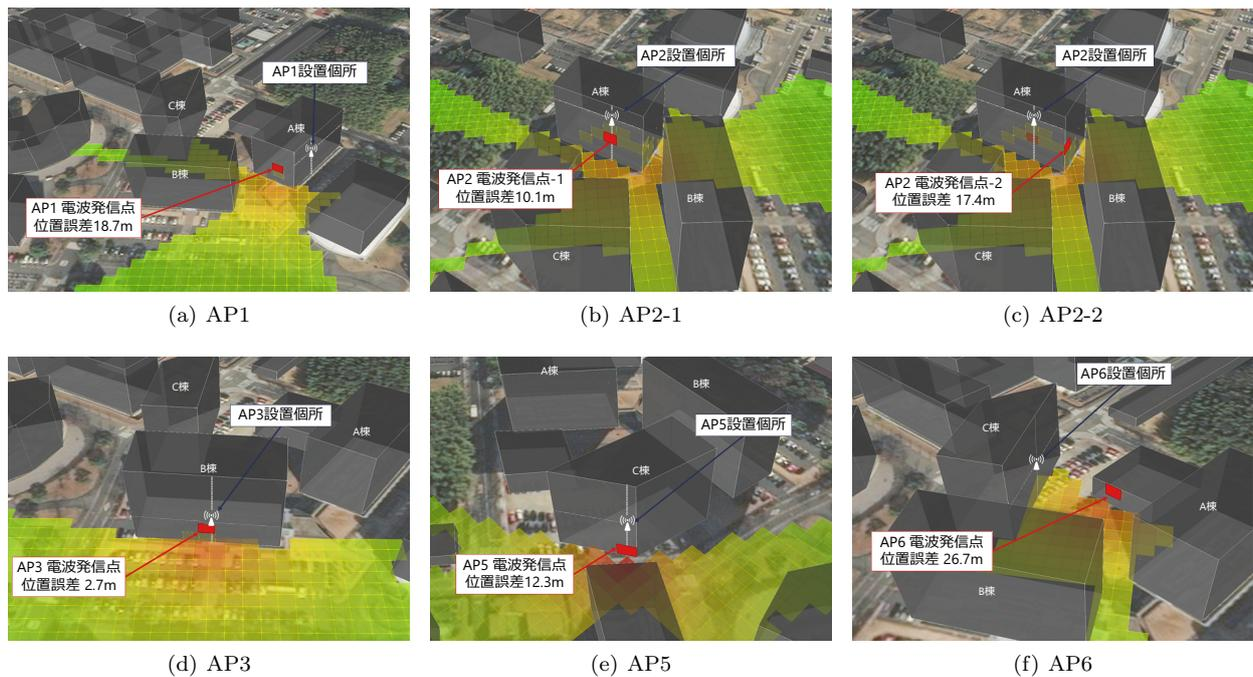
図 7 各 AP の設置箇所と電波発信点の推定位置
