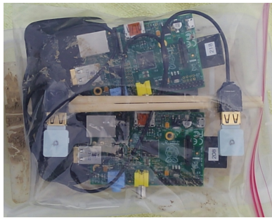
図 7 Raspberry Pi を 2 台使用した 2 チャンネル並列通信実験の無線通信端末
