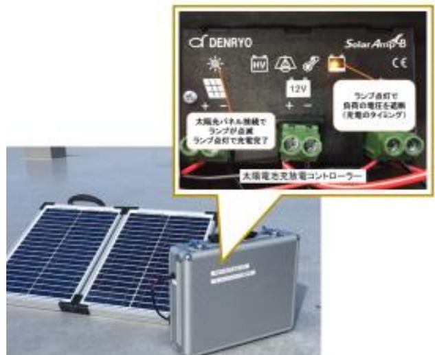
図2 実際に開発した太陽光発電システム
