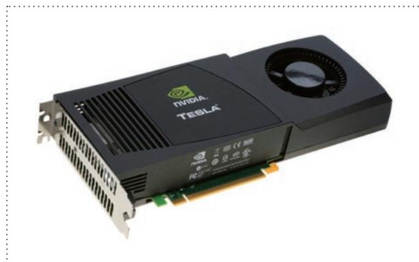
図-1 ビデオ出力端子を持たない GPGPU 専用カード
