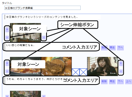
図 4: シーン伸縮型の映像レビュー記事の編集インタフェース。シーン伸縮ボタンを押して対象シーンを時間的に前後に伸縮させることによって、正確に対象シーンを提示・選択可能であり、対応するコメントの編集も可能である。
