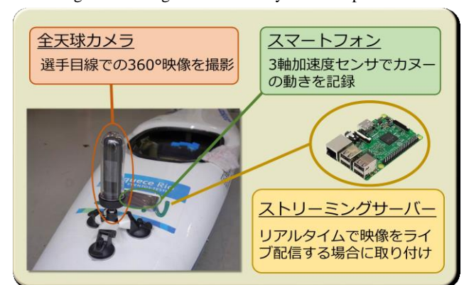
図2 選手側システム構成
