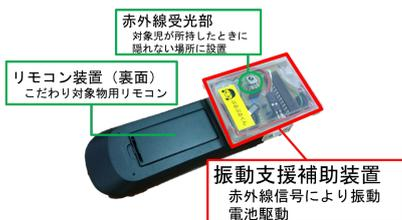
図2: リモコンに装着した振動式支援補助装置
