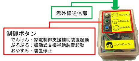
図4: 基本操作専用赤外線式リモコン
