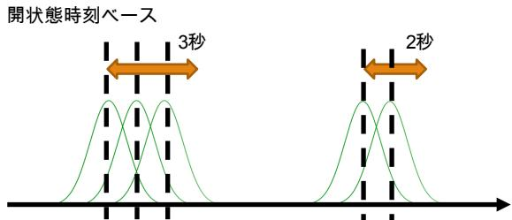
図 4 開状態時刻ベースにおけるカーネル密度推定の例
