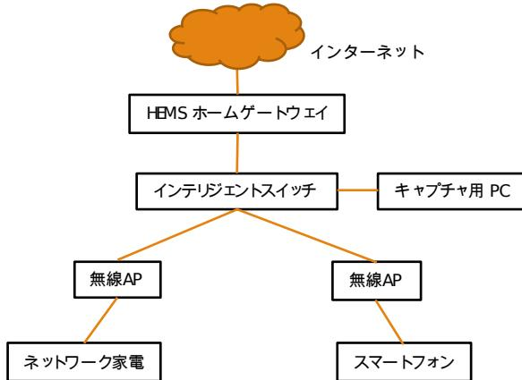
図 1 研究室に構築した模擬環境のネットワーク構成
