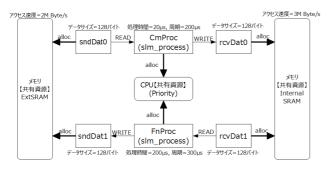
図 5 共有資源モデルを使用した対象システムモデル
