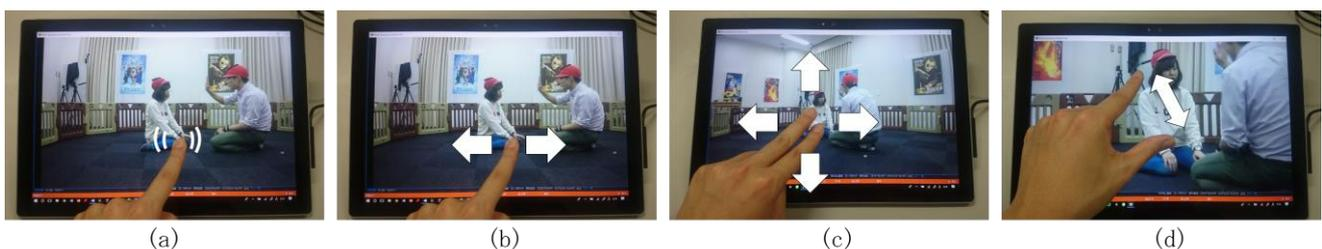
図2 タッチジェスチャ ((a)タップ, (b)ストローク1本, (c)ストローク2本, (d)ピンチイン・アウト)
