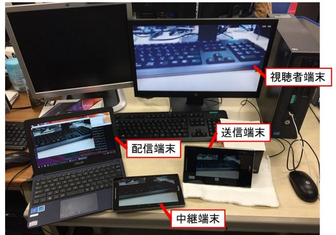
図 9 プロトタイプシステムの動作例
