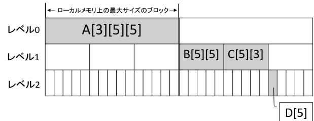
図6 図5における配列の整数分の1アジャスタブルブロックへの割り当て
