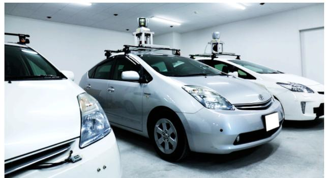
図3 本研究で用いた自動運転実験車両。車両上部に搭載されているのがLiDARセンサ。
