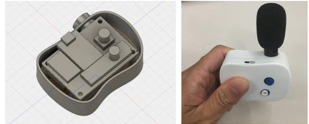
図3 動作検証用3Dモデル(左図)と実物(右図)
