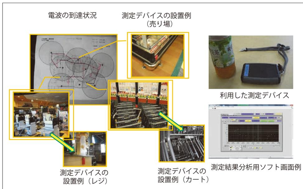
図-2 顧客行動を測定するためのセンサ例と実験システムのセンサ配置
